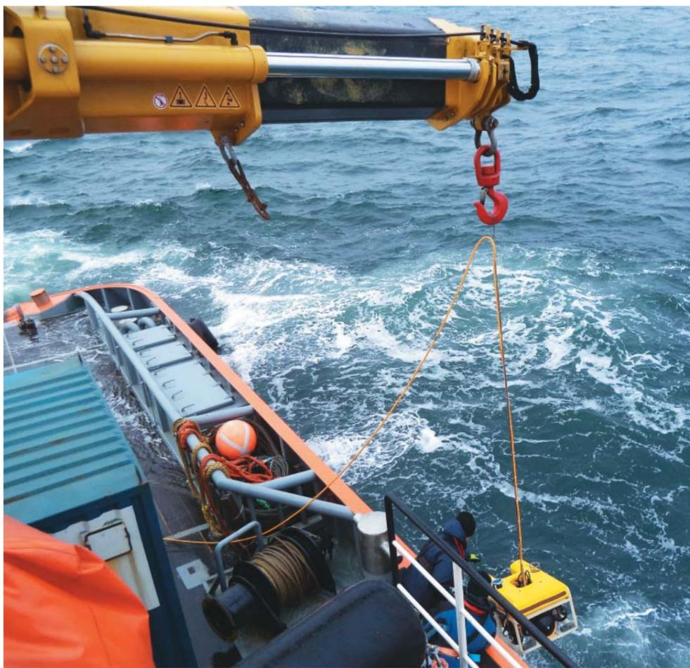
Спуск телеуправляемого обитаемого подводного аппарата на воду
