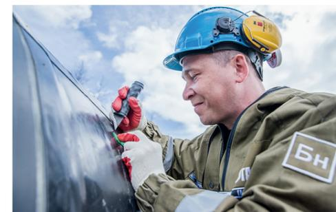
Проверка адгезии изолирующего покрытия трубы
