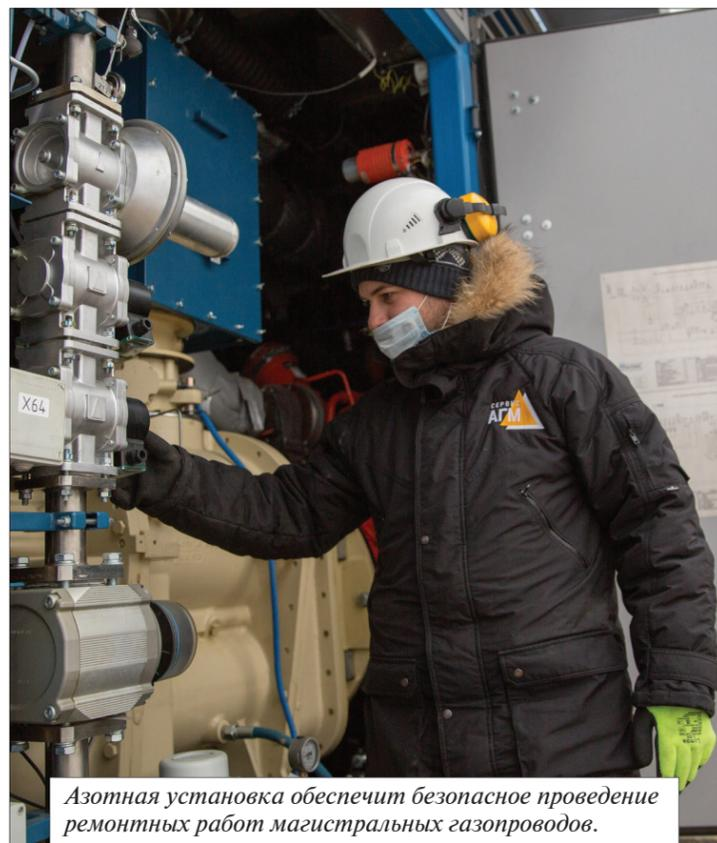
Азотная установка обеспечит безопасное проведение ремонтных работ магистральных газопроводов.
