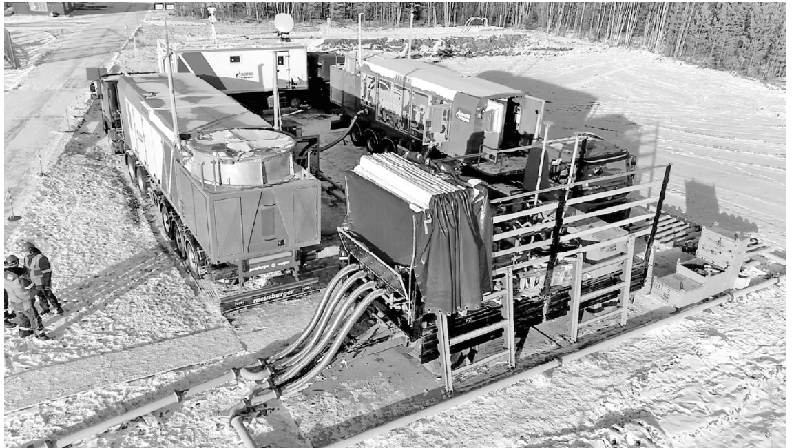
До конца 2020 года планируется сэкономить 117 млн. кубометров голубого топлива с применением мобильных компрессорных станций.
