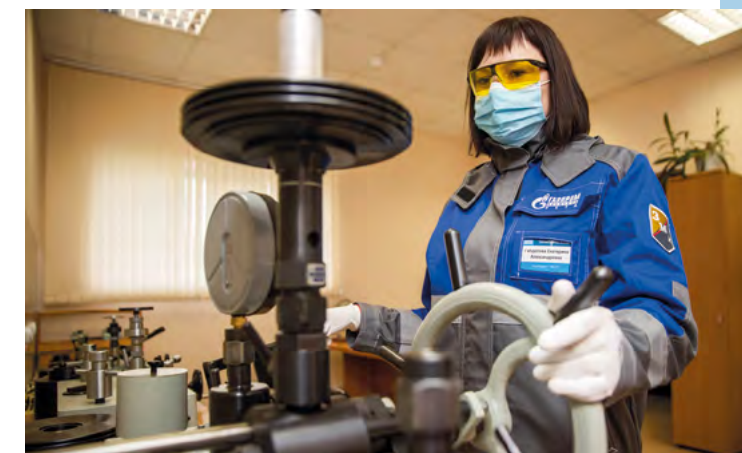
Екатерина Габделова, приборист группы метрологического обеспечения технологического процесса Сосногорского ЛПУМГ, делает калибровку технического манометра
