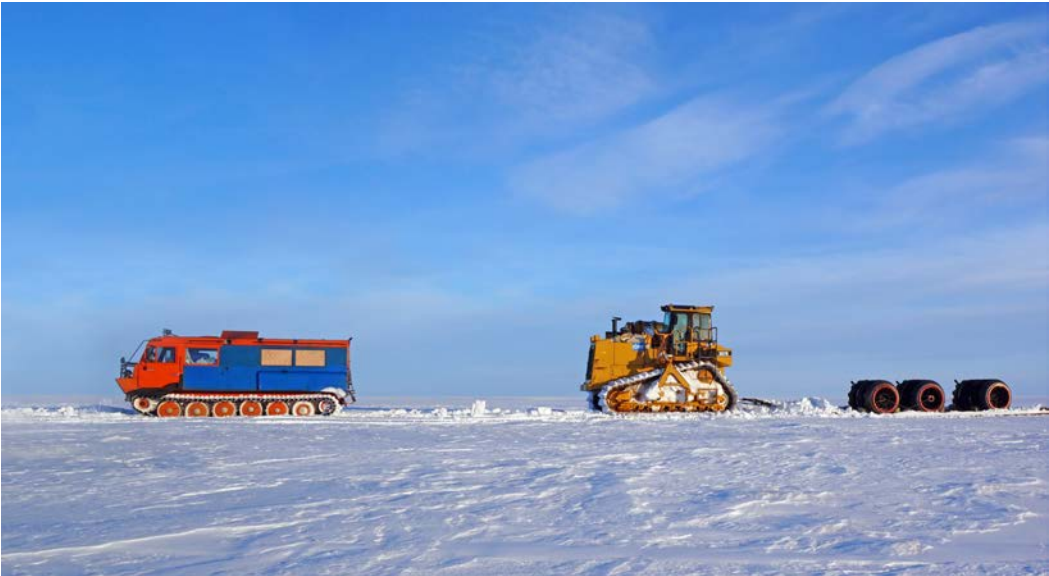
Перевозка внутритрубного оборудования на снях трубоукладчиком в паре с вездеходом
